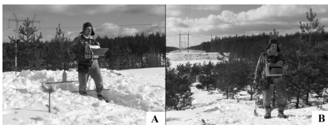
2. att. Radiolokācijas profilēšana ar dažādām centrālās frekvences antenu sistēmām: A – 150 MHz antenu sistēma, B – 2000 MHz antenu sistēma
