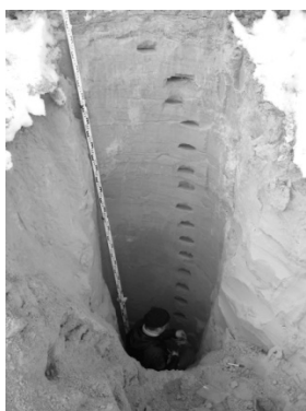
3. att. Paraugošanas darbi pētījuma vajadzībām izveidotajā skatrakumā.
